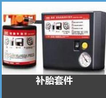
所谓的补胎应急包主要是由补胎液、充气泵、软管等套件组成，可以利用充气泵，通过软管等连接装置，将补胎液注入轮胎内，对轮胎的扎伤创口进行修补，实现应急处理。
